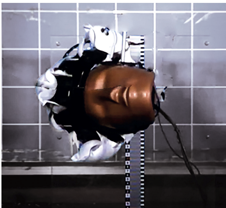
Figure 14 : Test du prototype du système de casque de vélo Airbag
